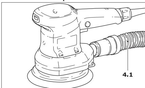
Afin d'éviter d'avoir à remplacer souvent le filtre turbo, on peut raccorder un aspirateur Festool à la place du dispositif d'auto-aspiration.
